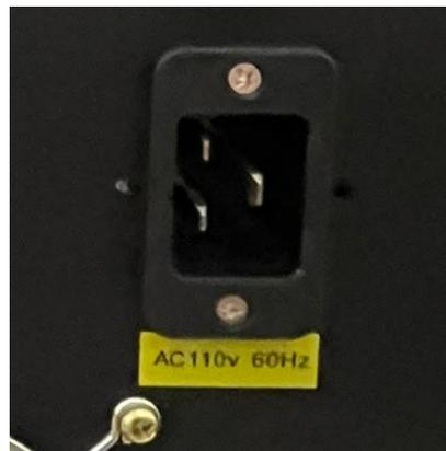
電源コネクターの一方を機械の背面に接続し、もう一方を主電源コンセントに挿入します。
