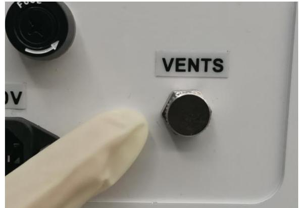
**ステップ1。** 満水時の排水口のキャップを外し、排水口の下に水容器を置きます。
